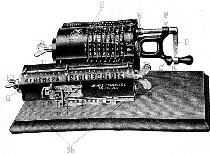
Brunsviga-Rechenmaschine (System Trinks)
