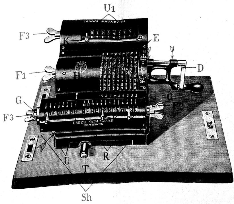
**Brunsviga-Rechenmaschine (System Trinks)**
