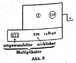
Bei den BRUNSVIGA-Rechenmaschinen mit Zehnerübertragung im Umdrehungszählwerk — den mit R bezeichneten Typen — erscheint stets der wirkliche Multiplikator.
